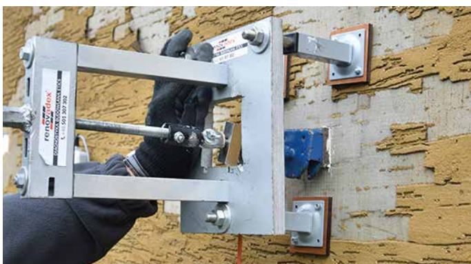
RYS.34 Pomiar wytrzymałości warstwy zbrojonej
