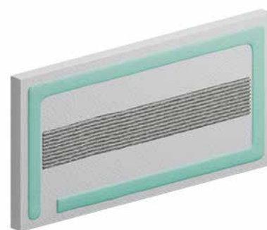
RYS.17 Klejenie metodą pasmowo-grzebieniową
