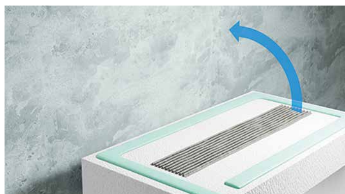
RYS.36 Przyklejenie płyty styropianowej
