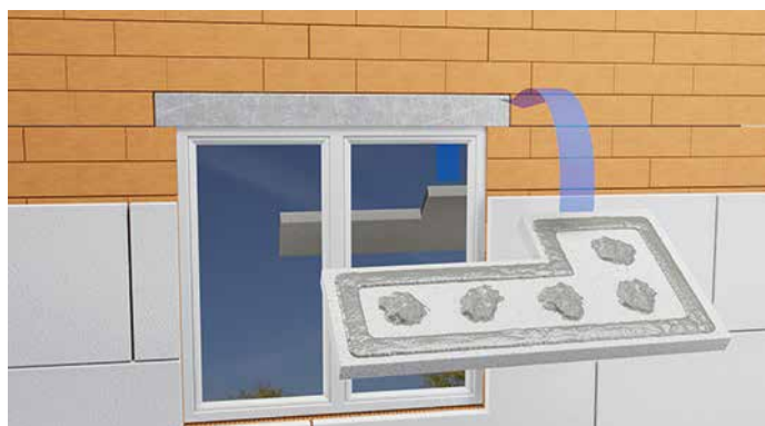
RYS.14 Prawidłowe przycinięcie styropianu w narożach
