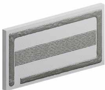
RYS.9 Klejenie metodą pasmowo-grzebieniową
