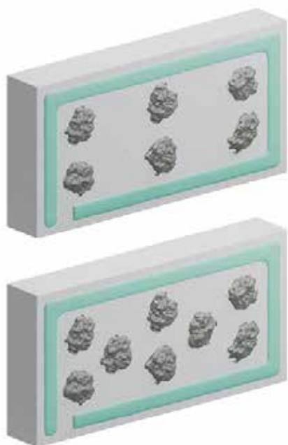
RYS.18 Poprawne ułożenie klejów na płytach styropianowych
