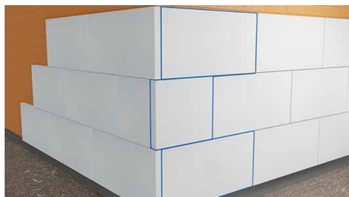
RYS.12 Rozmieszczenie mijankowe płyt styropianu
