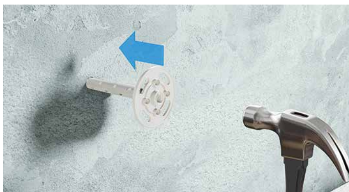
RYS.43 Wstępne kotwienie łącznika do podłoża
